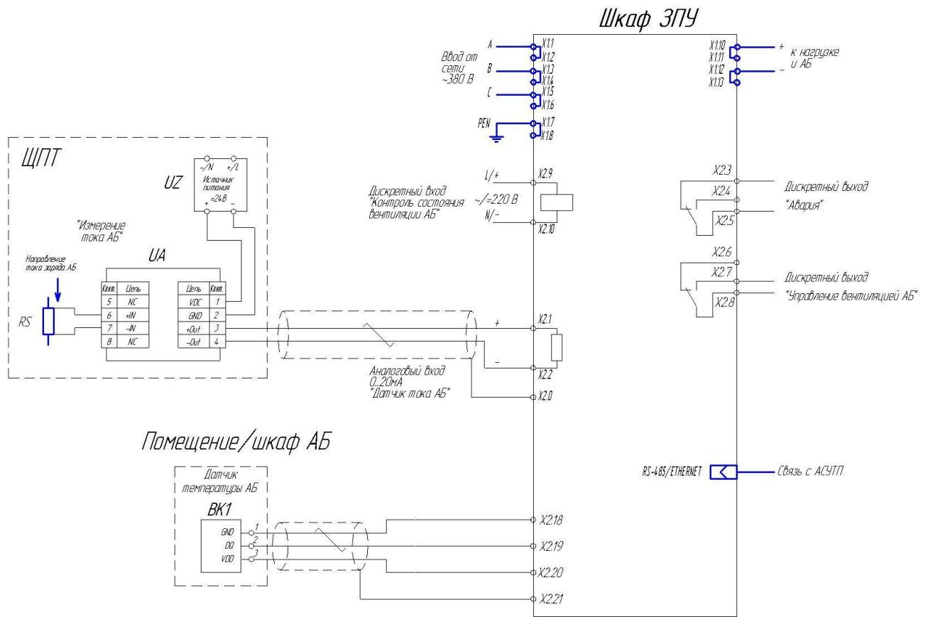
Схема внешних соединений ЗПУ
