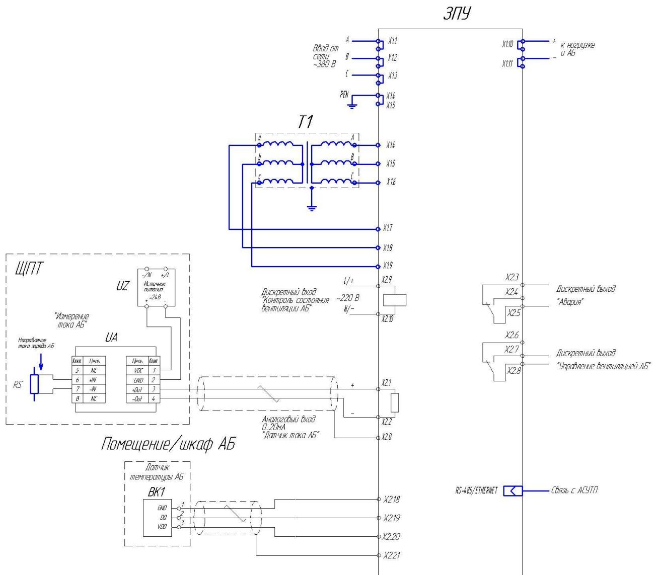
*Схема внешних соединений ЗПУ
