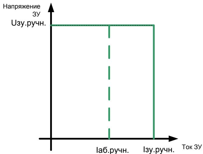
Рисунок 3 – Выходная статическая характеристика ЗПУ при работе в режиме «Ручной режим»
