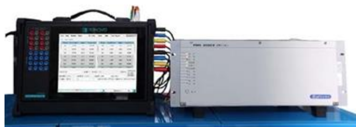
ПАТАР 500 & цифровое реле защиты Передача SV + Подписка GOOSE
